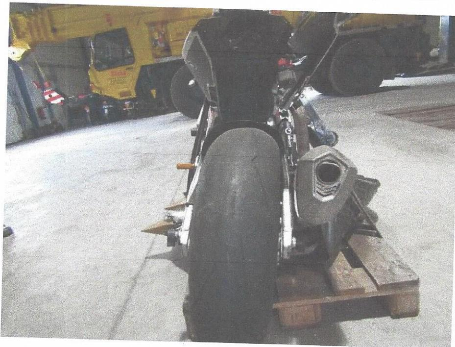
Bild 6 Fehlstellung Schwinge
