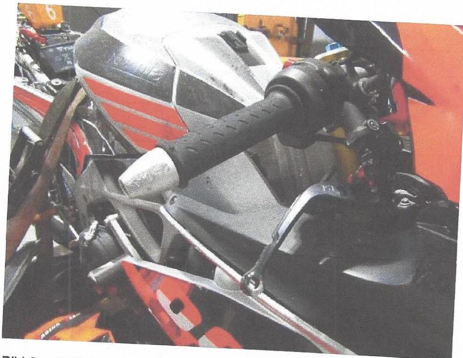
Bild 8 Griff, Hebel rechts verschrammt
