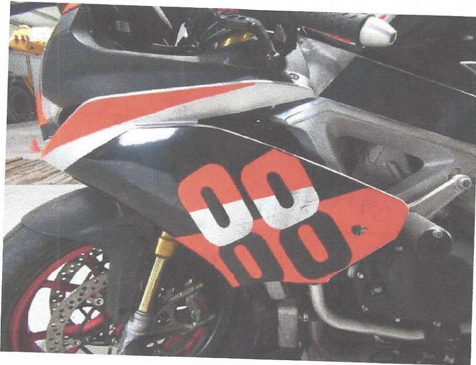
Bild 5 Fahrzeugverkleidung verschrammt und teilweise gebrochen
