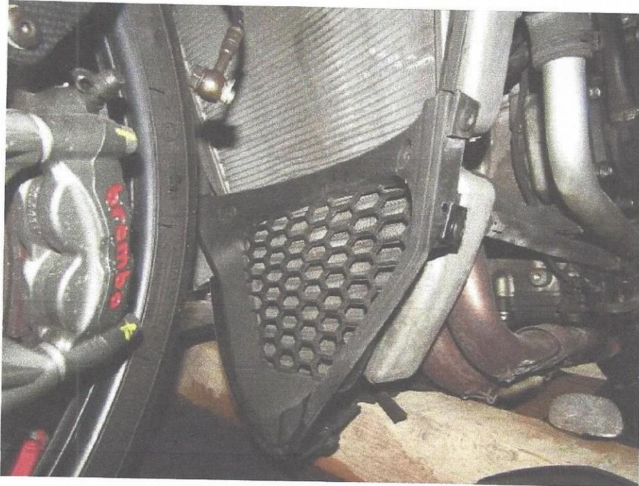
Bild 19 Verkleidung und Kühlerpaket vorne verformt
