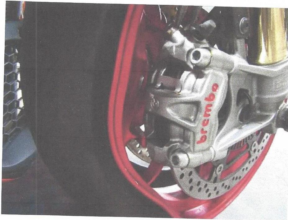
Bild 11 Rad, Bremssattel vorne verschrammt und verformt
