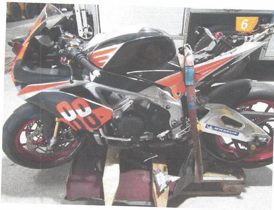
Bild 4 Fahrzeugverkleidung verschrammt und teilweise gebrochen
