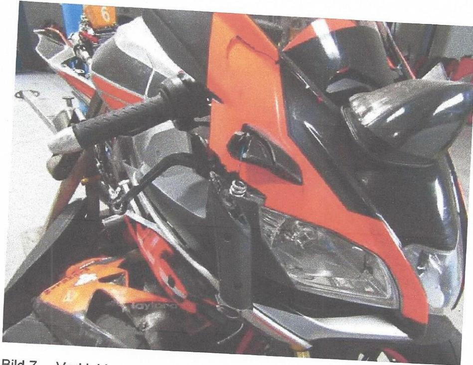
Bild 7 Verkleidung vorne, Griff rechts, Spiegel rechts verschrammt und gebrochen
