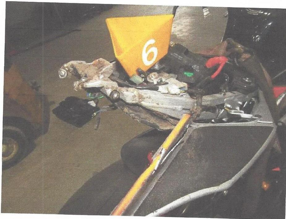
Bild 22 Fahrzeugheck verschrammt und deformiert
