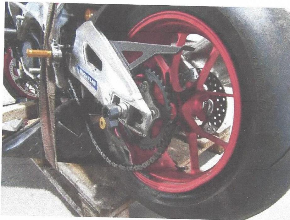
Bild 12 Rad hinten verschrammt und verformt, Antriebskette abgesprungen
