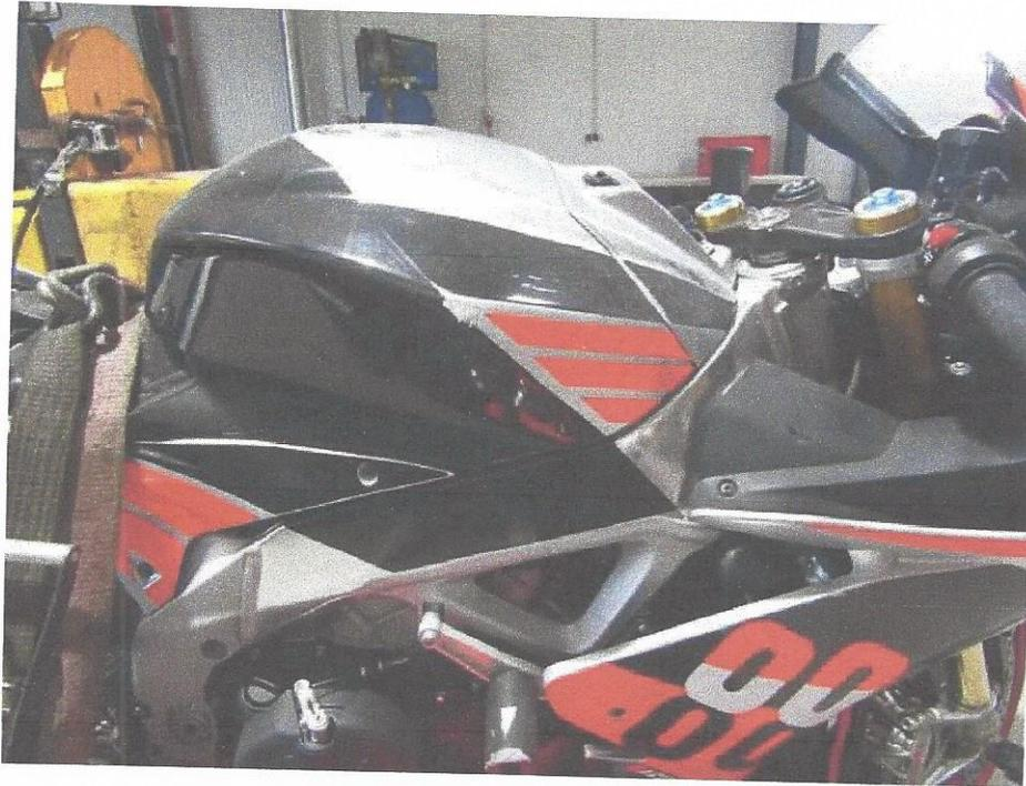
Bild 9 Tankverkleidung verschrammt und verformt
