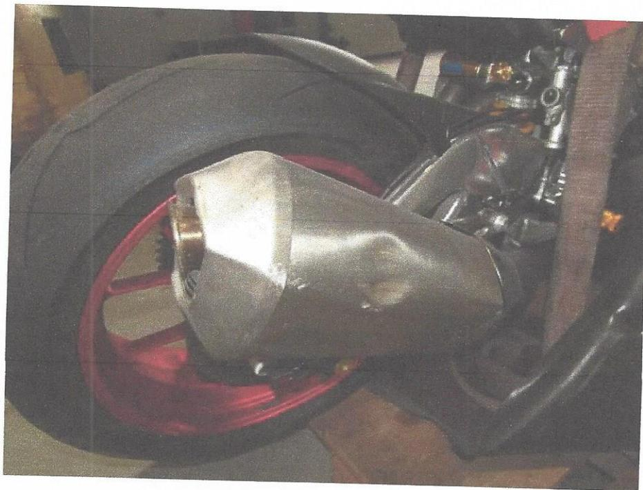
Bild 14 Endschalldämpfer verschrammt und verformt
