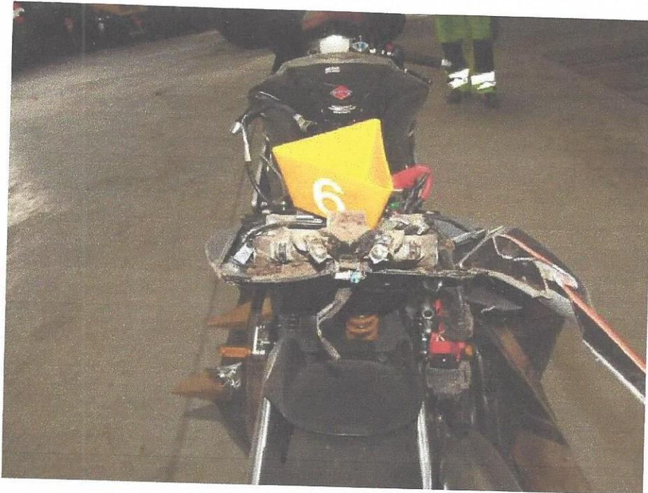
Bild 21 Fahrzeugheck verschrammt und deformiert
