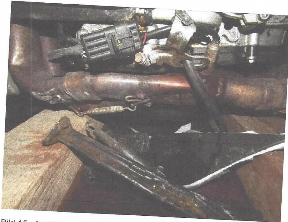
Bild 15 Auspffkrümmer verschrammt und verformt, Seitenständer abgebrochen
