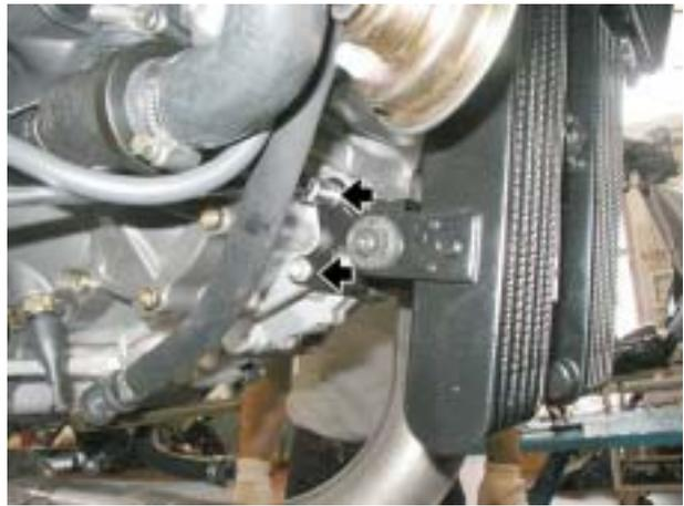
**WICHTIG** Die innere Mutter der oberen linken Schraube mit einem Schraubenschlüssel festziehen.
