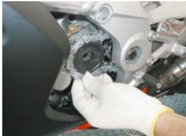
**WICHTIG** Auf das Gewinde der Schraube **LOCTITE® 243** auftragen.
