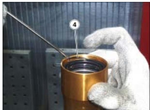
**WICHTIG** Eine Gummilasche am Rand des Gleitrohrs anordnen, so dass es bei der Abnahme der Ölabdichtung (5) nicht beschädigt wird.
