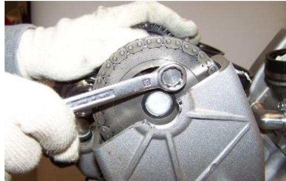
**Spezialwerkzeug****020850Y Blockiervorrichtung Zahnrad Hauptantriebswelle****020914Y Werkzeug zum Blockieren des Schwungrads**
