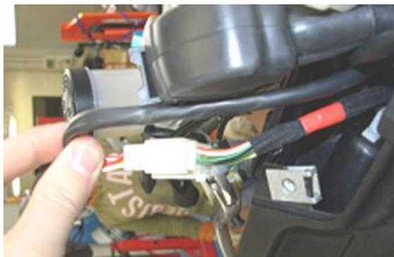
Der Stecker mit dem Kabel mit dem roten Band muss an die Buchse mit dem längeren Kabel angeschlossen werden.
