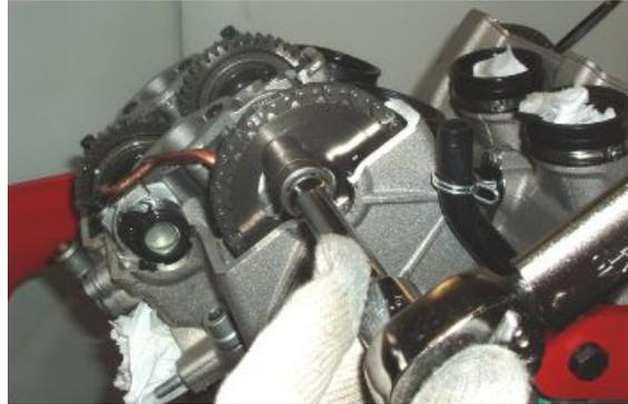
**Spezialwerkzeug****020851Y Steckverbindung Nockenwellenverstellung****020852Y Stift Einstellung Kurbelwelle**
