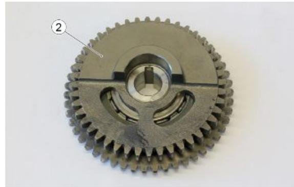
Bei Verformungen an der Lauffläche oder Materialbruch muss das Freilauf-Zahnrad (2) ausgewechselt werden.
