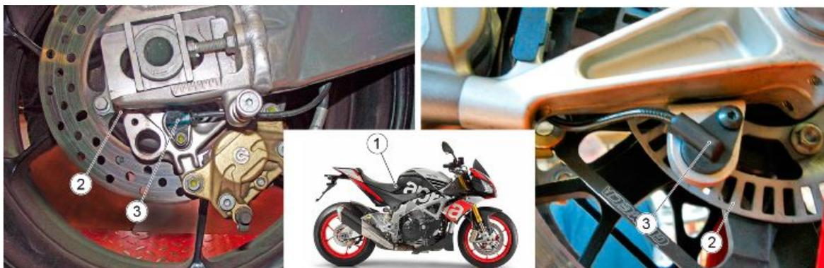
Wenn die Sensoren (3) einen beträchtlichen Unterschied zwischen der Geschwindigkeit des Vorder- und des Hinterrads erfassen (zum Beispiel beim Fahren auf nur einem Rad), könnte das ABS dies als eine Gefahrensituation interpretieren. In diesem Fall gibt es zwei Möglichkeiten:
