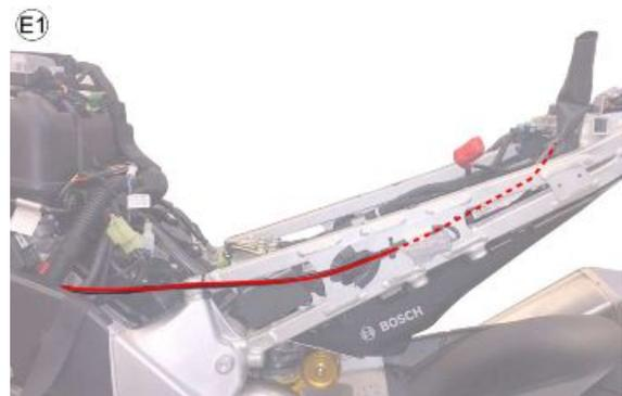
**TAFEL E2 - MASSE BATTERIE-MOTOR BEFESTIGUNGEN UND POSITIONIERUNG KABEL AM MOTOR AUF DEM RAHMEN**
