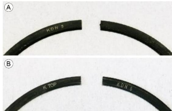
Die fünf Kolbenringstöße (zwei Kolbenringe, zwei Ölabbstreifringe, eine Ölabbstreiffeder) müssen um jeweils 90° untereinander versetzt eingebaut werden, beginnend bei der Stiftschraube an der Auslassseite gegenüber der Kette und dann weiter im Uhrzeigersinn.
