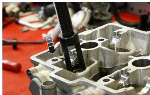
**Spezialwerkzeug****AP8140179 Kompressor Ventildfedern****020853Y Federteller für Einlassventil****020854Y Federteller für Auslassventil****Siehe auch**[Ausbau](#)
