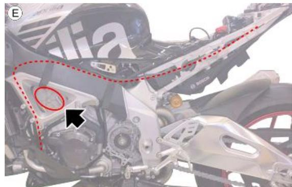
**TAFEL E1 - MASSE BATTERIE-MOTOR BEFESTIGUNGEN UND POSITIONIERUNG KABEL AM MOTOR AUF DEM RAHMEN**
