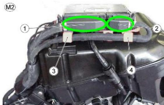
1. Kabelstecker Kabel ECU 1 (Ausgang "26")
