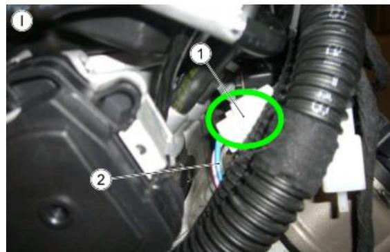
1. Kabelstecker Kabel Gangsensor (Ausgang "15")
